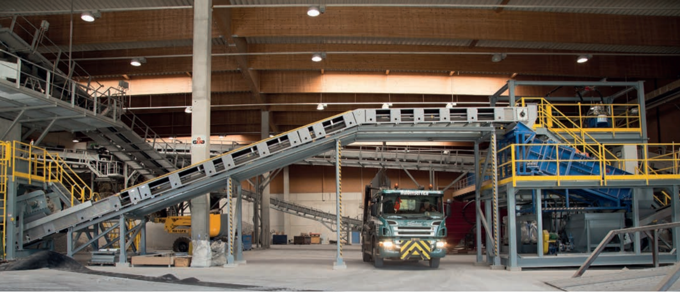
Mittels Feinschlackenaufbereitung gelangen auch kleinste Metallpartikel in den Stoffkreislauf zurück.
