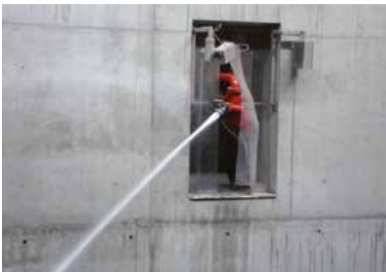
Löschkanone mit IR-Kamera
