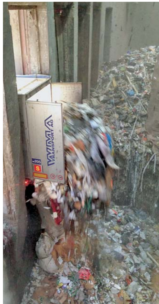
Abfallanlieferung in Kehrchtbunker
