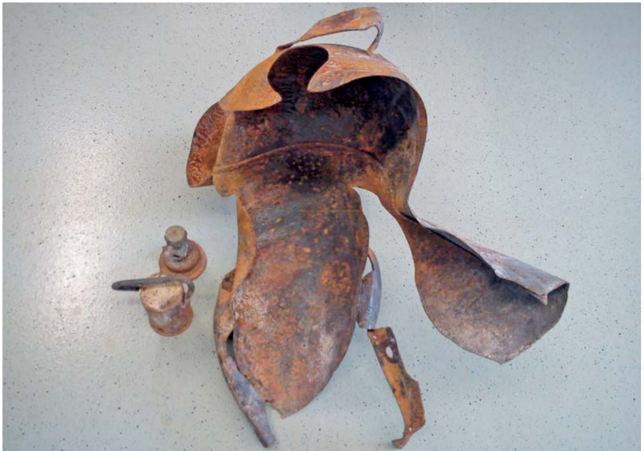
Im Ofen explodierte Gasflasche
